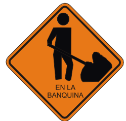
Trabajos en la Banquina T 8
