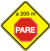
Proximidad de Señal Restrictiva (Pare) P 33
