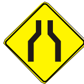
Estrechamiento (En las dos manos) P 10
