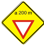
Proximidad de Señal Restrictiva (Paso) P 33
