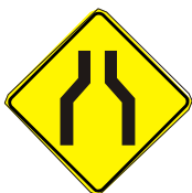
Estrechamiento (En las dos manos) P 10
