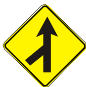
Incorporación de Tránsito Lateral P 22
