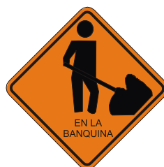
Trabajos en la Banquina T 8
