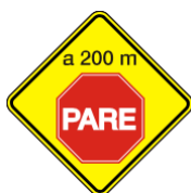
Proximidad de Señal Restrictiva (Pare) P 33
