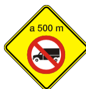
Proximidad de Señal Restrictiva (Otras) P 33
