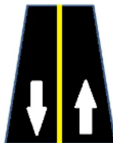
No se puede cambiar de carril para maniobra de adelantamiento
